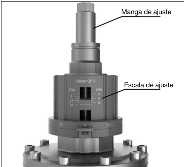
Figura 2 Manga de ajuste (debe ser desatornillada antes de modificar el ajuste)
