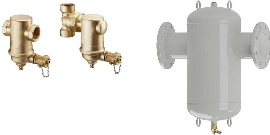
Les séparateurs de boues éliminent en continu les plus petites particules de saleté sans augmenter de manière significative la résistance au débit. Un aimant puissant retient la magnétite en place. Lorsque l'aimant est retiré, les particules magnétiques tombent dans le puisard et peuvent être évacuées via un robinet à tournant sphérique sans interrompre le fonctionnement.
