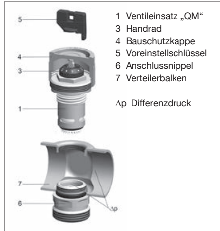
Abb. 5.1 Aufbau Ventileinsatz „QM“
