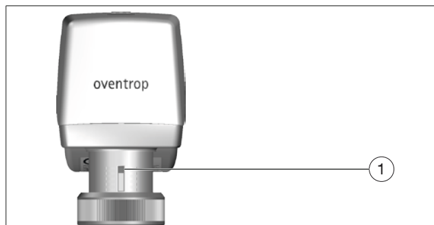
Fig. 10 : Position supérieure de la levée
