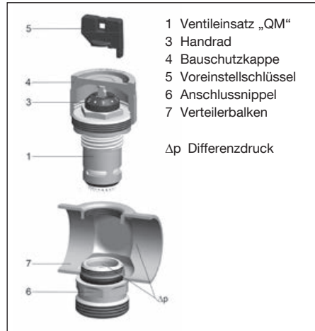
Abb. 5.1 Aufbau Ventileinsatz „QM“
