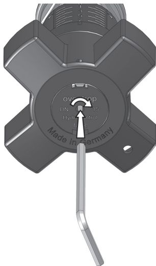
Fig. 11 : Limitation de la tige de réglage
