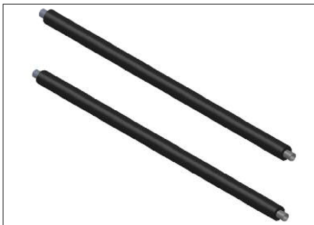
Fig. 1 Tuyau de raccordement du capteur: tuyau annelé en acier inoxydable avec isolation et soufflet protecteur résistant aux rayons UV et aux morsures d'animaux.
