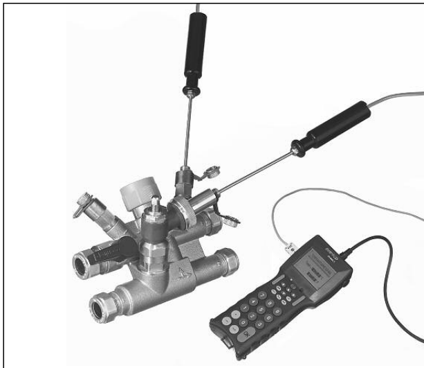
Bild/Illustr./Fig. 5 Messung der Temperatur des Sekundärkreises Temperature measurement of terminal unit Mesure de la température du circuit secondaire
