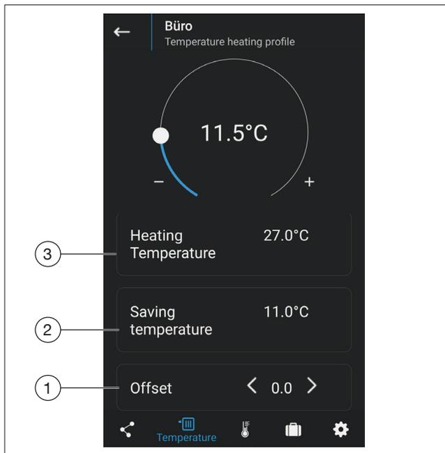
Illust. 8: Ajuste de temperaturas en el modo automático
