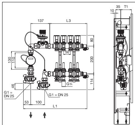
Fig. 2 Exemple : Jeu de raccordement pour compteurs de calories, modèle équerre et distributeur/collecteur «Multidis SF» pour installations de surfaces chauffantes, longueurs et profondeur
