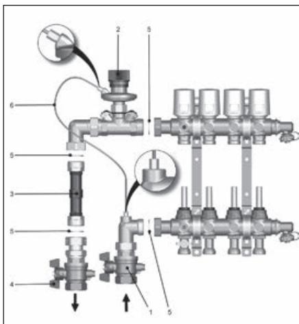
Abb. 4: Wärmemengenzähler-Anschluss-Set, Eckform, Lieferumfang und Anordnung der Komponenten bei Linksanschluss.
