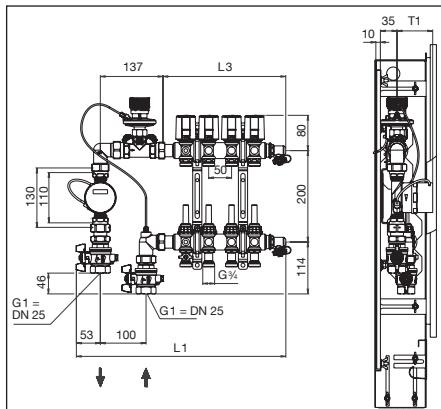
Abb. 2 Beispiel: Wärmemengenzähler-Anschluss-Set, Eckform und „Multidis SF“ Edelstahl-Verteiler für Flächenheizung, Baulängen und Bautiefe
