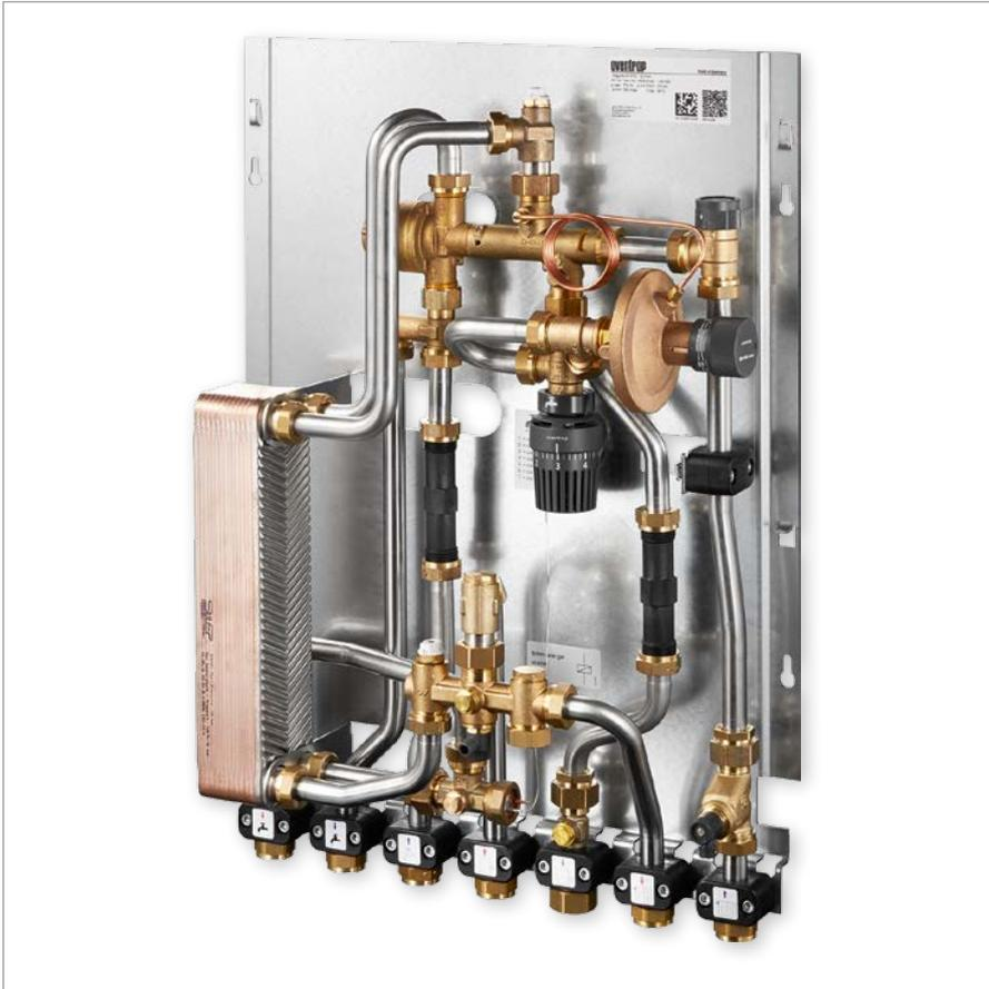
„Regudis W-HTU“ Wohnungsstation mit Plattenwärmeübertrager zur Übertragung der Wärme aus einer zentralen Wärmeversorgung an die Sanitär- und Heizungsanlage einer Wohnung.
