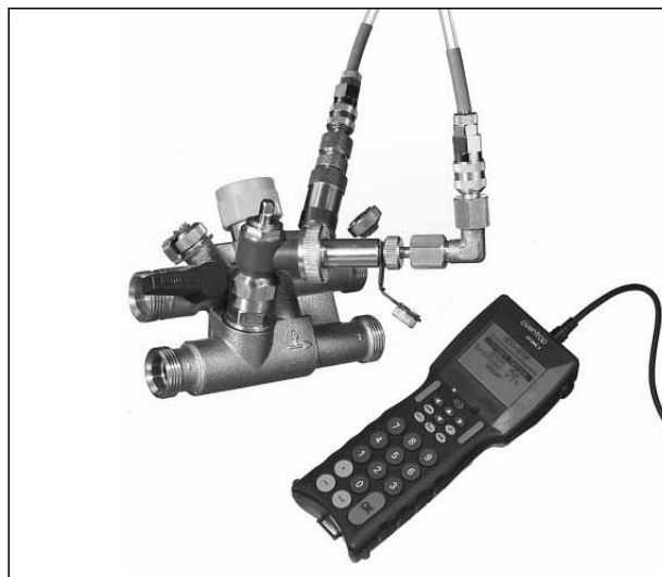
Bild 6 Messung des Differenzdruckes des Sekundärkreises
