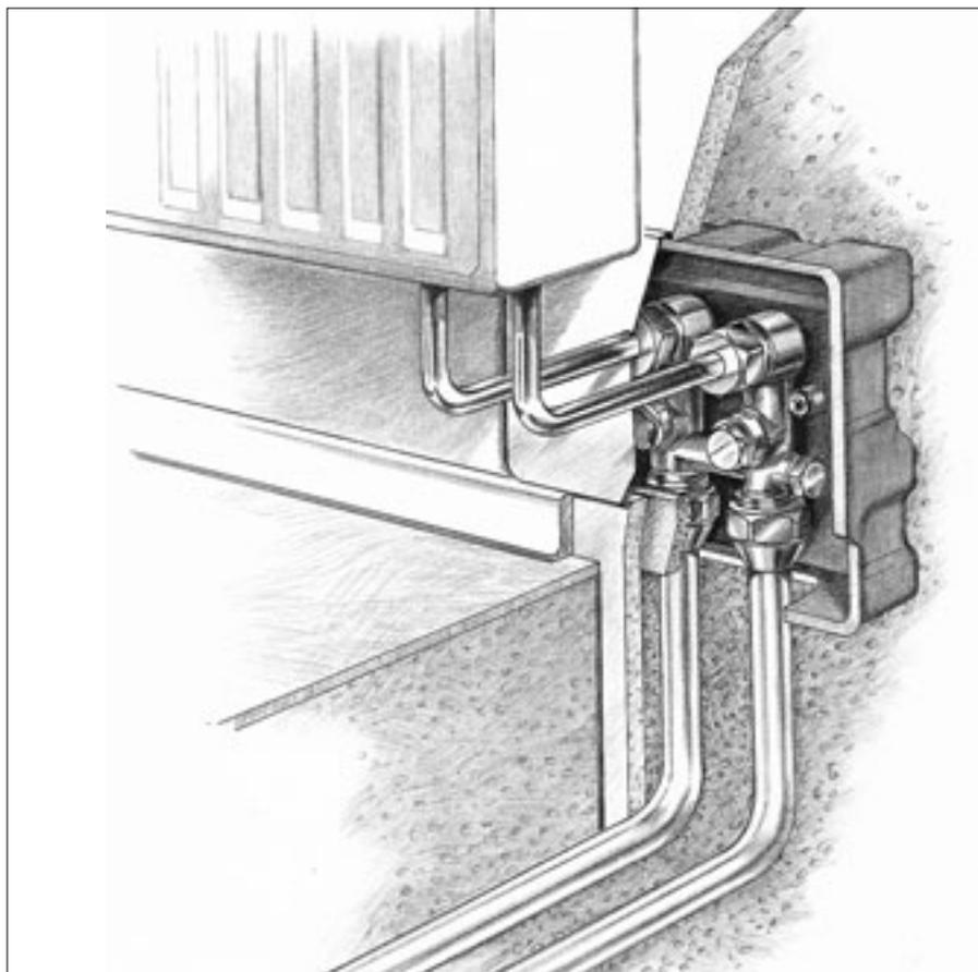
Die „Multimodul“ Heizkörperanbindung ermöglicht die Installation und Inbetriebnahme der Heizungsanlage ohne Heizkörper. Sie ist insbesondere für den Anschluß von Heizkörpern mit integrierter Ventilgarnitur einsetzbar.
