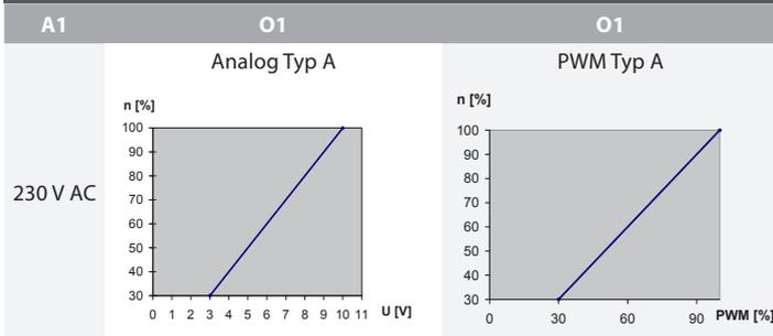
A1 keine Drehzahlsteuerung, nur Schaltbetrieb aus/ein. Mindesteinschaltzeit 5sec.
