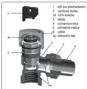
Obr. 2 Konstrukce ventilu „AQ“
