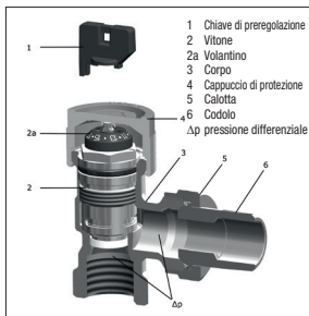
Fig.2 Struttura della valvola termostattizzabile «AQ»
