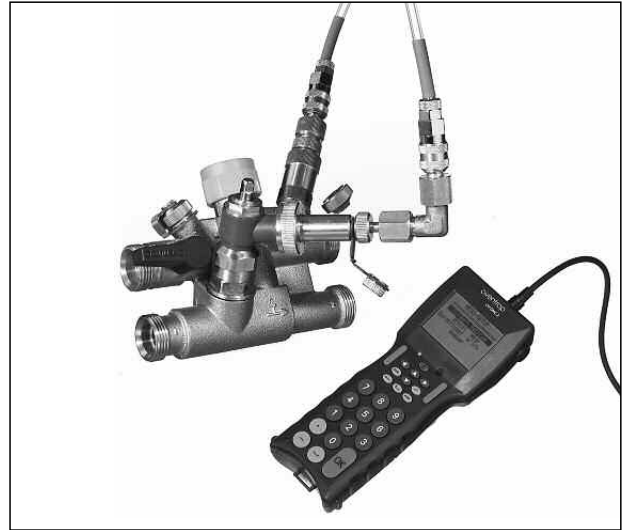
Bild 6/Illustr. 6 Messung des Differenzdruckes des Sekundärkreises Differential pressure measurement of terminal unit Mesure de la pression différentielle du circuit secondaire
