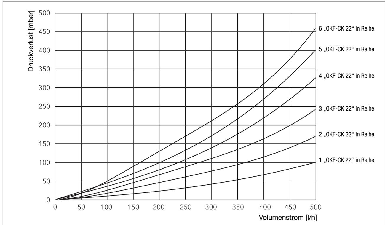
Druckverlust für mehrere in Reihe geschaltete Kollektoren in Abhängigkeit vom Volumenstrom.
