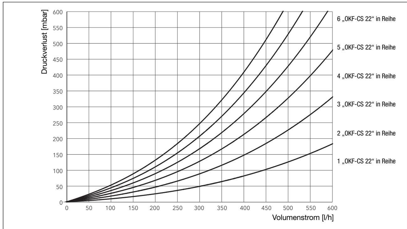
Druckverlust für mehrere in Reihe geschaltete Kollektoren in Abhängigkeit vom Volumenstrom.
