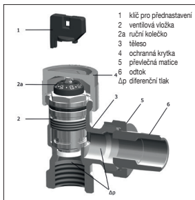
Obr. 2 Konstrukce ventilu „AQ“
