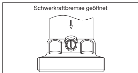
Abb. 6.7 Befüllen der Anlage
