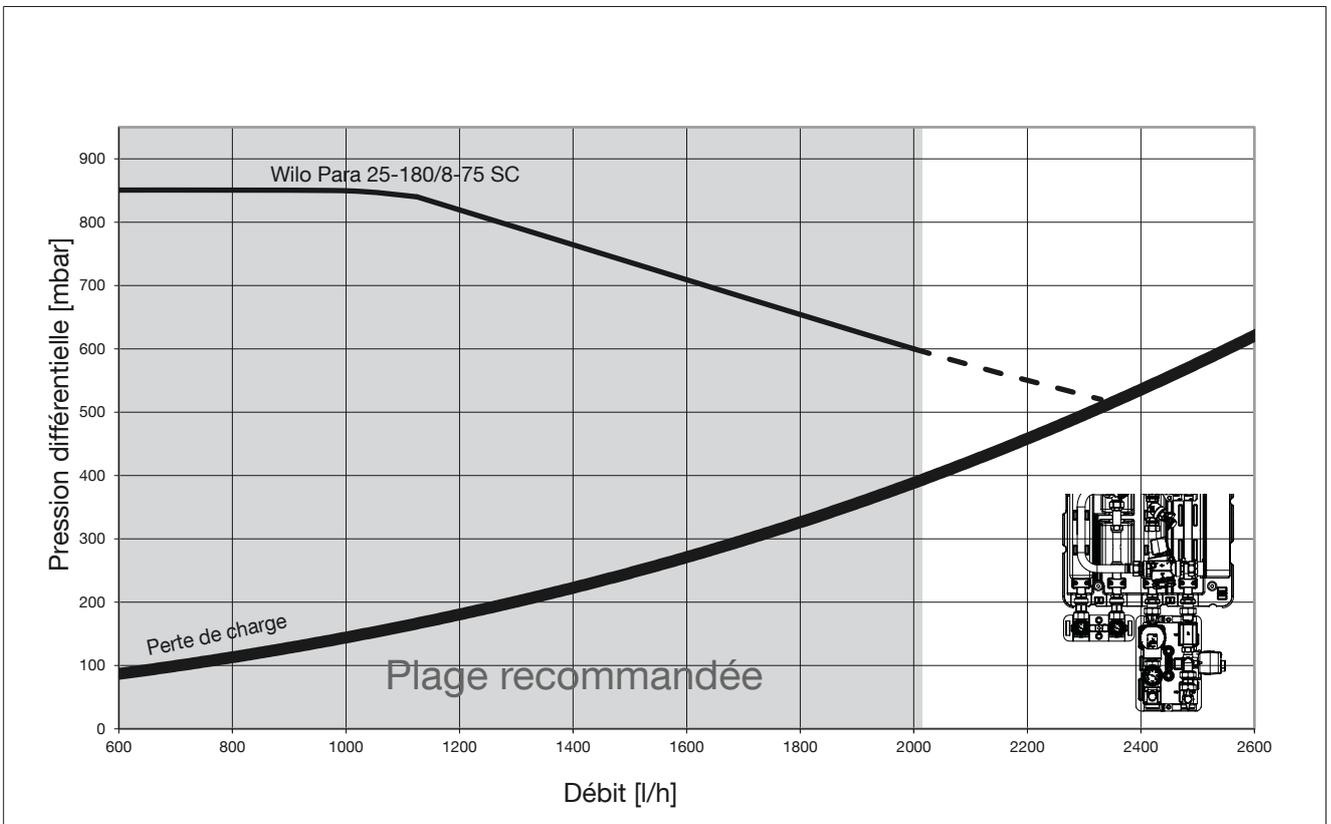
Fig. 5: Perte de charge circuit secondaire Regudis H-HT
