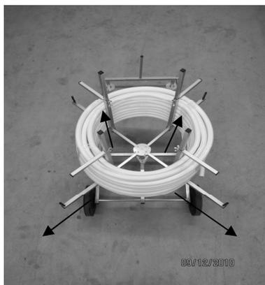
8. Zwei Arme herausziehen, bis Fixierarme am Rohrbund anliegen. Fixierarme an Rohrbundhöhe anpassen. Haspel ist einsatzbereit
