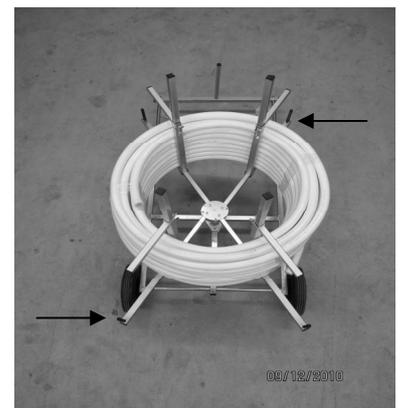
9. Die Haspelbreite kann durch schwenken von zwei Armen (z.B. an eine Türbreite) angepasst werden.
