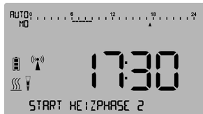
Abbildung 52: Display-Anzeige Startpunkt HEIZPHASE 2
