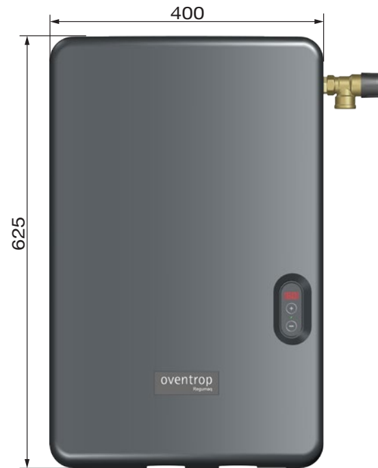
Abb. 5: Abmessungen Regumaq X-25 mit Oberschale
