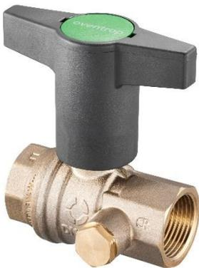
Kugelhahn für Trinkwasseranlagen mit reduziertem Durchgang nach DIN EN 13828 und voll durchspültem Kugelhinterraum, tottraumfrei.
