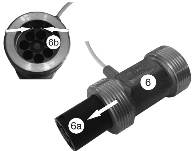
Abb. 5.16: Überwurfmuttern Volumenstromsensor lösen
