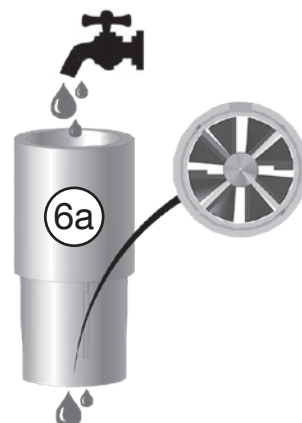
Abb. 5.18: Messturbine unter fließendem Wasser reinigen
