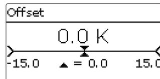
→ Um den Offset für einen Sensor festzulegen, den Wert mit den Tasten **2** und **4** einstellen und mit Taste **5** bestätigen
