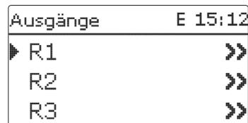
Unter diesem Menüpunkt kann für jedes Relais des Reglers und der externen Module die Ansteuerungsart und die Minimaldrehzahl eingestellt werden.
