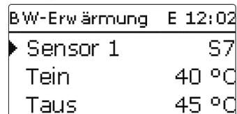
Die Brauchwassererwärmung dient dazu, durch Anforderung einer Nachheizung den Brauchwasserspeicher zu erwärmen.
