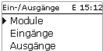
Im Menü **Ein-/Ausgänge** können externe Module an- und abgemeldet, Sensoroffsets eingestellt und Relaisausgänge konfiguriert werden.
