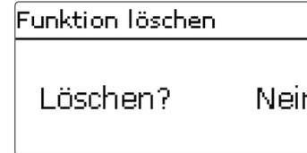
Wird der Punkt **Funktion löschen** mit Taste **5** bestätigt, erscheint eine Sicherheitsabfrage. Mit den Tasten **2** und **4** kann zwischen **Ja** und **Nein** gewechselt werden. Wird **Ja** eingestellt und mit Taste **5** bestätigt, ist die Funktion gelöscht und steht wieder unter **neue Funktion...** zur Verfügung. Die entsprechenden Relais sind wieder freigegeben.
