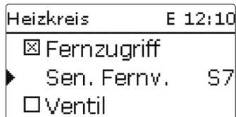
Bei der Sensorauswahl stehen nur Ausgänge zur Verfügung, die zuvor im Menü **Eingänge/Ausgänge** als Eingang für einen Fernzugriff eingestellt worden sind.
