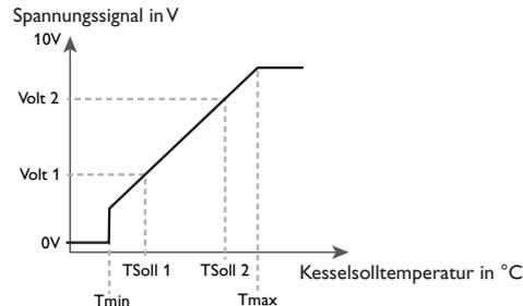
Mit den Einstellkanälen **Tmax** und **Tmin** können die Maximal- und Minimaltemperaturen für die Kesselsolltemperatur eingestellt werden.
