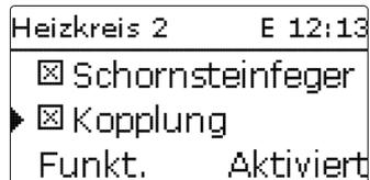
Die Schornsteinfegerfunktion ist in allen Heizkreisen werksseitig aktiviert. Der Schornsteinfegermodus kann aktiviert werden, indem Taste
