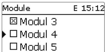
In diesem Untermenü können bis zu 5 externe Module angemeldet werden. Alle angeschlossenen und vom Regler erkannten Module stehen zur Auswahl.
