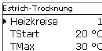
Wird die Taste **6** für mindestens 5 s gedrückt, wird das Programm Estrich-Trocknung ausgelöst.
