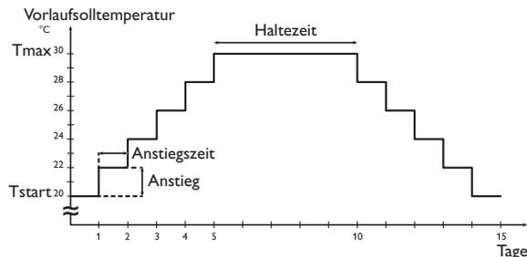
Das Diagramm zeigt die Parameter der Estrich-Trocknung mit den Werkseinstellungen.
