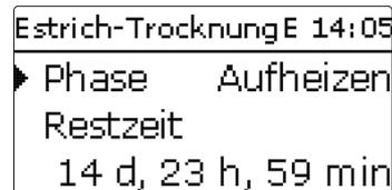
Wird die Taste **6** erneut für mindestens 5 s gedrückt, wird die Estrich-Trocknung vorzeitig beendet. Aus diesem Grund folgt eine Sicherheitsabfrage. Die Sicherheitsabfrage nur bestätigen, wenn die Estrich-Trocknung abgebrochen werden soll.
