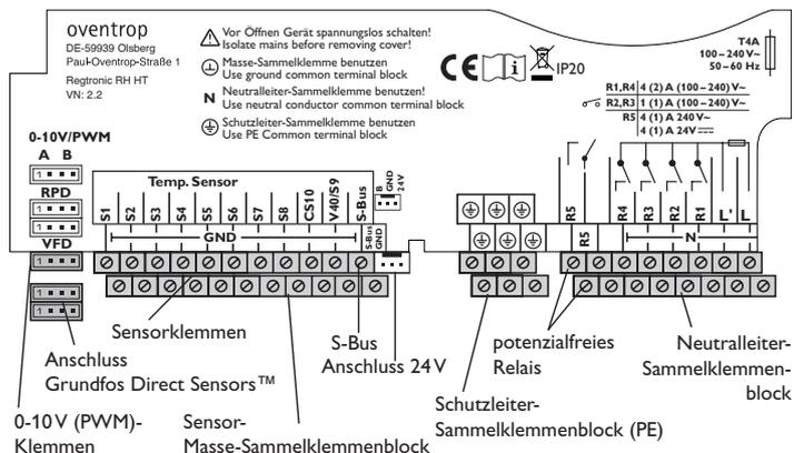
Den **Einstrahlungssensor** unter Beachtung der Polung an die Klemmen CS10 und GND anschließen. Dazu den am Sensor mit GND gekennzeichneten Anschluss mit dem Masse-Sammelklemmenblock GND, den mit CS gekennzeichneten Anschluss mit der Klemme CS10 verbinden.
