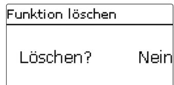
Wird der Punkt **Funktion löschen** mit Taste **5** bestätigt, erscheint eine Sicherheitsabfrage. Mit den Tasten **2** und **4** kann zwischen **Ja** und **Nein** gewechselt werden. Wird Ja eingestellt und mit Taste **5** bestätigt, ist die Funktion gelöscht und die entsprechenden Relais sind wieder freigegeben.
