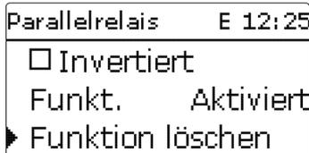
Am Ende jedes Untermenüs zu einer Wahlfunktion stehen die Punkte **Funktion** und **Funktion löschen**.
