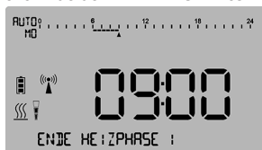
Abbildung 50: Display-Anzeige Endpunkt HEIZPHASE 1
