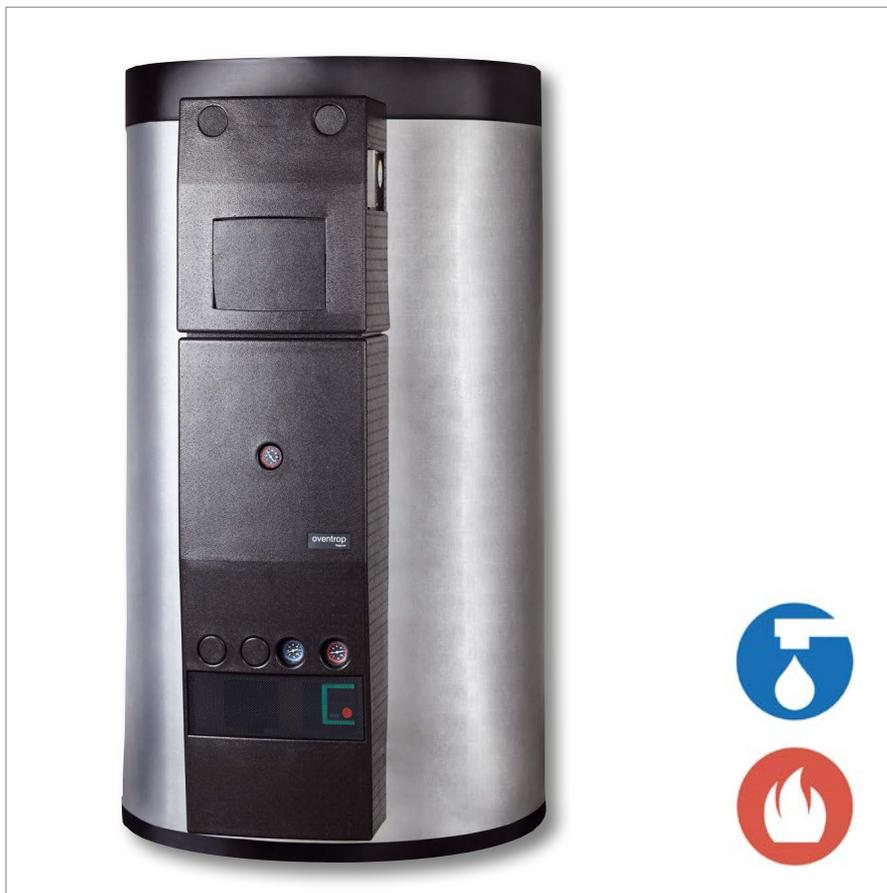
Die Energiespeicher-Zentrale „Regucor WH“ dient zur Versorgung von Ein- und Zweifamilienhäusern mit Heizungswärme und warmem Trinkwasser. Der Aufbau ist identisch zum „Regucor WHS“, jedoch ohne Solarstation und ohne elektronischen Regler. Die Möglichkeit für eine spätere Nachrüstung der Solaranbaugruppe ist allerdings vorbereitet, ein Solarwärmeübertrager ist bereits im Speicher integriert.
