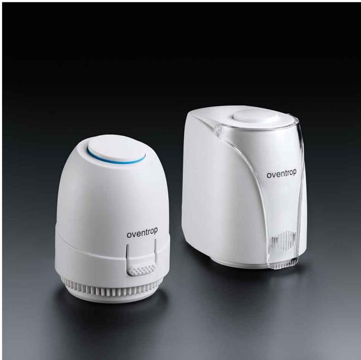
Elektrothermische Stellantriebe mit 2-Punkt-Verhalten. Je nach Anforderung 230 V bzw. 24 V (links) sowie Elektrothermische Stellantriebe 24 V mit stetigem Stellverhalten als Proportional- Antrieb (0–10 V) (rechts).
