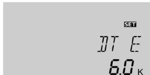
Der Regler verhält sich wie eine Standard-Differenzregelung. Bei Erreichen der Einschalttemperaturdiff. wird die Pumpe eingeschaltet. Wenn die Temperaturdifferenz die eingestellte Ausschalttemperaturdifferenz erreicht oder unterschreitet, schaltet das entsprechende Relais aus.
