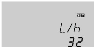
Zeigt den gemessenen momentanen Volumenstrom in der Solaranlage an. Dieser dient der Ermittlung der übertragenen Wärmemenge (V40).
