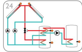
24 Solarsystem mit Ost-/Westdach, Schichtenspeicher und Wärmeaustausch (Seite 59)
