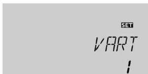
Die Wärmemengenzählung bzw. -bilanzierung kann auf 3 verschiedene Arten erfolgen (siehe unten): ohne Volumenmessteil, mit Volumenmessteil V40 oder mit Grundfos-Sensor.
