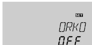
Die Funktion wird innerhalb eines vorgegebenen Zeitfensters aktiv, beginnend bei **RKAN** und endend bei **RKEN**. Sie schaltet die Kollektorkreispumpe für die einstellbare Laufzeit (**RKLA**) zwischen den einstellbaren Stillstand-Intervallen (**RKSZ**), um die verzögerte Temperaturerfassung auszugleichen.
