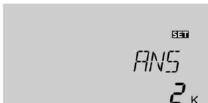
Bei Erreichen der Einschalttemperaturdifferenz wird die Pumpe eingeschaltet und für 10 s mit einer Drehzahl von 100% gefahren. Danach sinkt die Drehzahl auf die Minimaldrehzahl ab.
