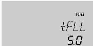
Mit dem Parameter **tFLL** wird die Befüllzeit eingestellt. Während dieser Zeit wird die Pumpe mit 100 % Drehzahl gefahren.
