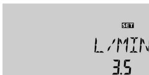
Zeigt den gemessenen momentanen Volumenstrom in der Solaranlage an. Dieser dient der Ermittlung der übertragenen Wärmemenge (VFS).
