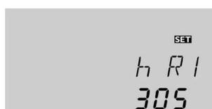
Der Betriebsstundenzähler summiert die Betriebsstunden des jeweiligen Relais (**h R1 / h R2 / h R3 / h R4**). Im Display werden volle Stunden angezeigt.
