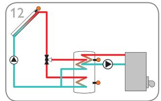
Solarsystem mit Schichtenspeicher und thermostatischer Nachheizung (Seite 31)
