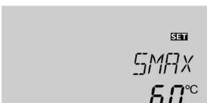
Wenn die Speichertemperatur die eingestellte Maximaltemperatur erreicht, wird eine weitere Speicherladung verhindert und somit eine schädigende Überhitzung vermieden. Bei überschrittener Speichermaximaltemperatur blinkt ► im Display.
