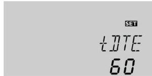
Mit dem Parameter **tDTE** wird die Zeitspanne, in der die Einschaltbedingung dauerhaft gegeben sein muss, eingestellt.
