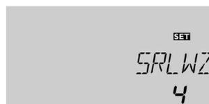
Wenn als Volumenstromerfassung VMAX oder V40 eingestellt wurde, können der Vorlauf- und der Rücklaufsensor für die Wärmemengenzählung ausgewählt werden.
