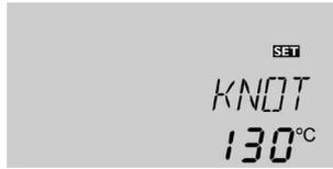
Wenn die Kollektortemperatur die eingestellte Kollektorgrenztemperatur (**KNOT / KNOT1 / KNOT2**) überschreitet, schaltet die Solarpumpe (R1 / R2) aus, um einer schädigenden Überhitzung der Solarkomponenten vorzubeugen (Kollektornotabschaltung). Bei überschrittener Kollektorgrenztemperatur blinkt im Display
