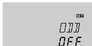
Durch die Drainback-Option **ODB** fließt das Wärmeträgermedium zurück in den Vorratsbehälter, wenn eine Solarernte nicht möglich ist. Wenn die Drainback-Funktion aktiviert ist, können die im Folgenden beschriebenen Einstellungen vorgenommen werden (**tD<sub>TO</sub>**, **tF<sub>LL</sub>** und **tS<sub>TB</sub>**):
