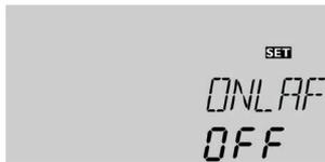
Mit dieser Funktion wird die Beladung des Speichers auch nach Unterschreiten der Ausschalt Differenz zwischen Kollektor und Speicher fortgesetzt. Sie schaltet ab, wenn die eingestellte DT-Nachlaufdifferenz zwischen Vor- und Rücklaufsensor unterschritten wird.
