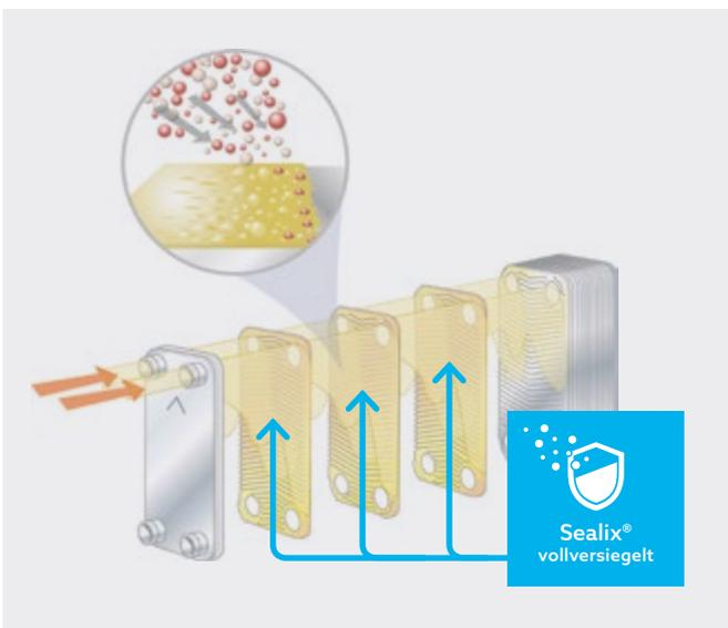
Versiegelt mit Siliciumdioxid für zusätzliche Sicherheit an Einsatzorten mit kritischen Wasserverhältnissen (Chloridanteil bis zu 150 mg/l)
