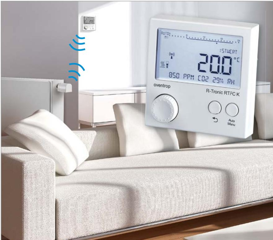
Die „mote“ Funk-Stellantriebe werden über Funk z.B. am Heizkörper gesteuert. Es können maximal drei „mote“ Stellantriebe im Batteriebetrieb an einer „R-Tronic“ angelernt werden – mit Hilfe eines Netzteils sind bis zu acht Stellantriebe möglich. Alle Einstellungen werden bequem am Funk-Thermostaten vorgenommen und der Status des Systems wird angezeigt.
