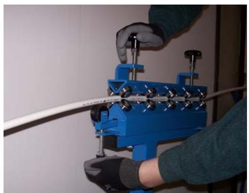
Если после первого прогона трубы еще не полностью выровнена, поджимающий ролик (3) поджать с помощью настроечного винта и подвигать трубу в устройстве взад и вперед. Изгиб, образовавшийся вследствие сматывания трубы в бухту, должен быть устранен.
