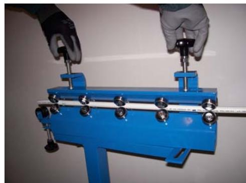
Si le tube n'est pas encore complètement droit après le premier dressage, pousser le rouleau de pression (3) contre le tube à l'aide de la vis d'ajustage et bouger le tube dans l'outil en avant et en arrière. De cette manière, le cintrage causé par l'enroulement du tube.
