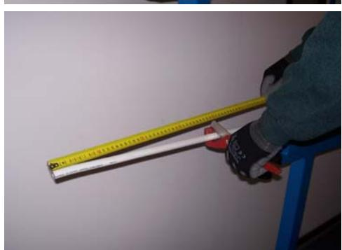
Ist das Rohr nach dem ersten Richten noch nicht vollständig gerade, die Andrückrolle (3) mit Hilfe der Einstellschraube gegen das Rohr drücken und das Rohr im Rohrrichtwerkzeug vor und zurück bewegen. Dadurch wird die Biegung, die durch das Aufrollen des Rohres entstanden ist beseitigt.
