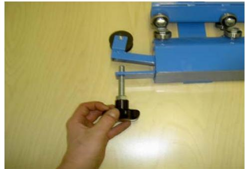
Einstellschraube lösen und in das Gewinde der Schraubenthalterung einschrauben.
