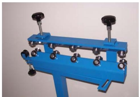
Ajuster le rail à rouleaux du haut (5) à l'aide des vis d'ajustage (2) de telle manière qu'il soit adapté au diamètre de tube correspondant.
