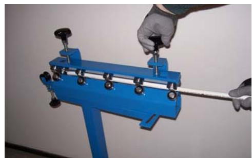
Introduire le tube dans les paliers à rouleaux de l'outil à dresser jusqu'à ce qu'il soit enfoncée complètement. Serrer les vis d'ajustage (2) jusqu'à ce que les paliers à rouleaux touchent le tube légèrement. Ne pas serrer à fond afin d'éviter un endommagement du tube.
