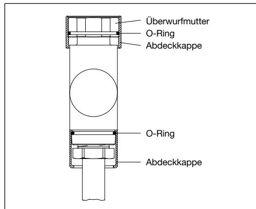
Nach der Montage der Durchgangverschraubungen die erforderliche Länge der Abdeckhalbschalen ermitteln. Abstand Fußboden bis Heizkörperverschraubung (Maß H) + 3 mm. Die Abdeckschalen gegebenenfalls kürzen.
