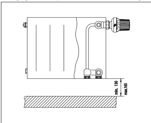
Bei der Montage der Heizkörperverschraubungen die Abdeckkappe zum Heizkörper zurückschieben und die Abdeckkappe zur Rohrseite auf das Rohr stecken. Nach der Montage die Abdeckkappen über die Überwurfmutter bzw. über den Sechskant schieben. Falls erforderlich, die O-Ringe anfeuchten.
