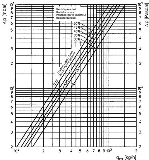
**Zweirohrbetrieb (Bypass-Schraube geschlossen)**
