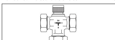
Fig. 51 Robinet à trois voies pour le réchauffage en deux zones (113 02 06).
