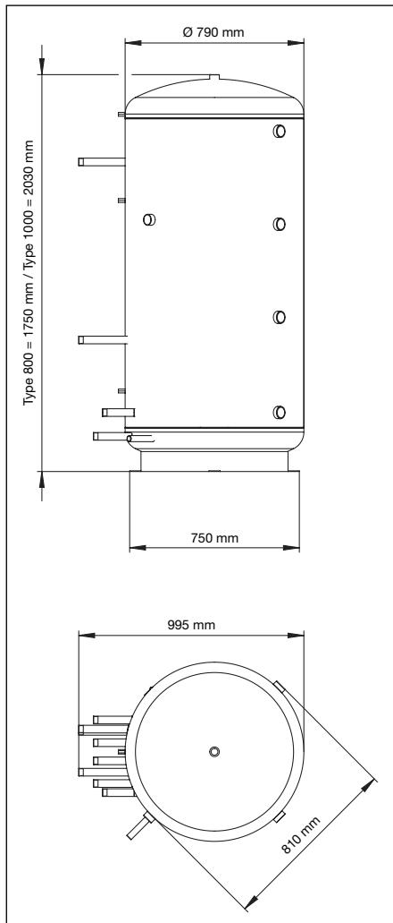
Fig. 42 Encombrements ballon d'eau chaude sans isolation
