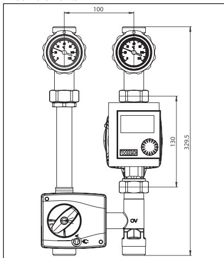
Fig. 28 Encombrements «Regumat M3-130» DN 20
