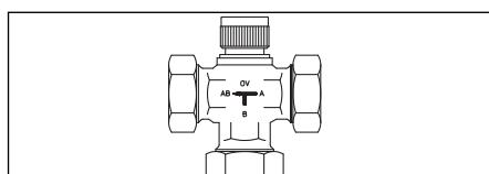
Fig. 50 Robinet à trois voies pour le réchauffage en deux zones (113 17 06).
