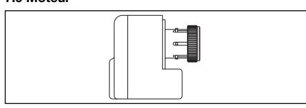
Fig. 52 Moteur pour la commande d'un robinet à trois voies (101 27 10).
