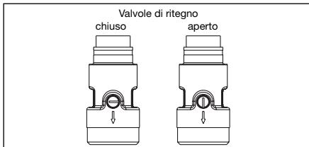
In posizione di funzionamento la valvola di intercettazione è chiusa. Il flusso è possibile soltanto in direzione di pompaggio.
