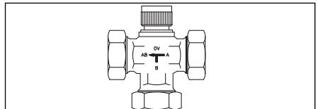
Fig. 50 Valvola a tre vie per il carico di due zone (1131706).
