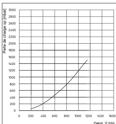
**Perte de charge circuit primaire (circuit ballon d'eau chaude) avec puisage d'eau maximal**
