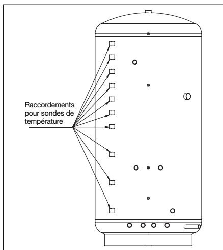
Fig. 6 Ballon d'eau chaude avec isolation démontée
