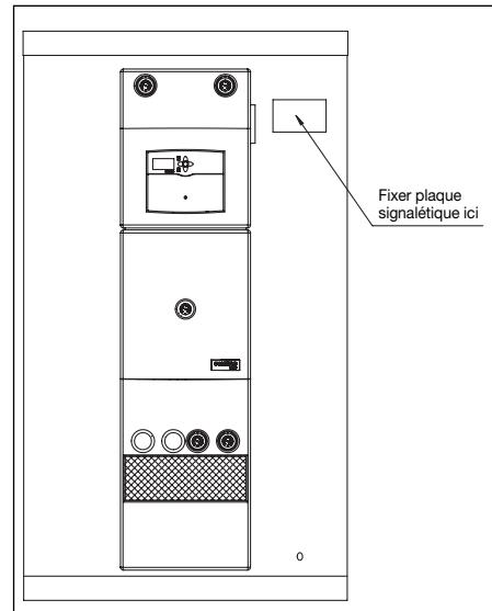
Fig. 23 Fixation de la plaque signalétique
