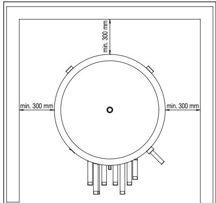
Fig. 3 Encombrements de montage
