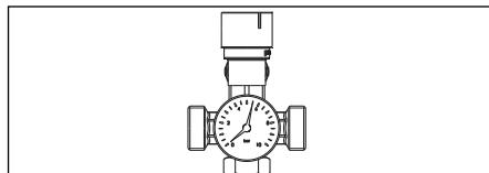
Fig. 48 Pour montage dans la colonne avec soupape de sécurité 6 bar pour raccords à serrage «Regusol» (136 42 48).
