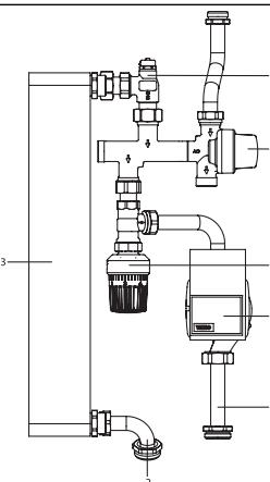
Fig. 31 Circuito primario
