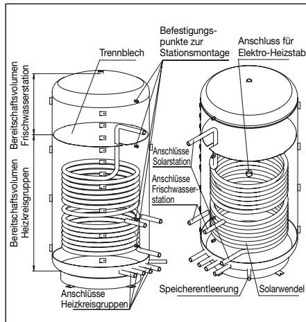
Abb. 43 Funktionsschnitt
