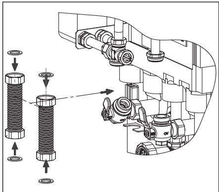
Abb. 14 Montage Metallwellrohre
