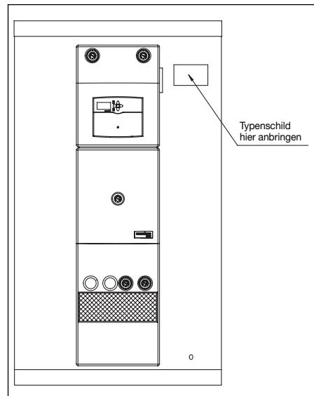
Abb. 23 Anbringung Typenschild
