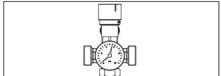
Fig. 48 Per il montaggio su colonna con valvola di sicurezza 6 bar per raccordo di serraggio "Regusol" (136 42 48).
