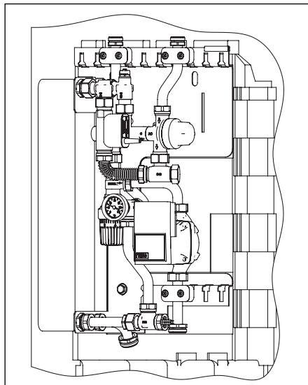
Fig. 13 Montage de la station d'eau potable
