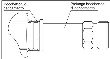
Fig. 5 Prolunga montata per bocchettone di caricamento
