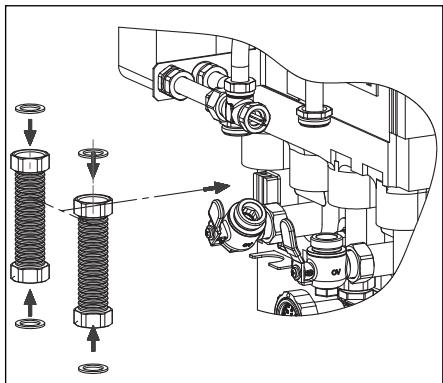
Fig. 14 Montage des tubes annelés métalliques
