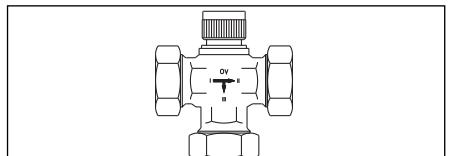
Fig. 51 Valvola a tre vie per il carico di due zone (1130206).
