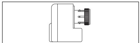
Fig. 52 Servomotore per il controllo della valvola a tre vie (1012710).
