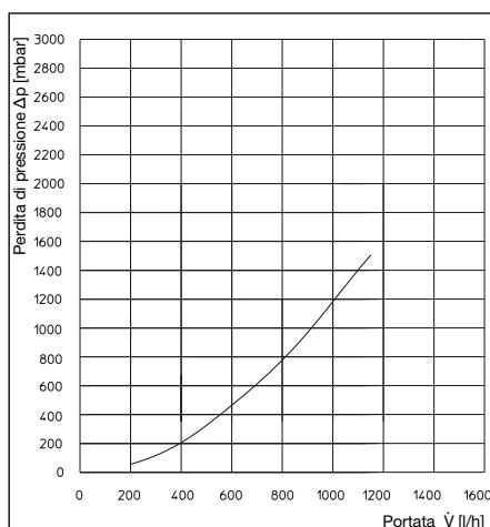
**Perdita di pressione circuito primario (Circuito serbatoio) a massimo prelievo acqua calda sanitaria**
