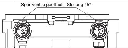
Abb. 39 Sperrventile geöffnet
