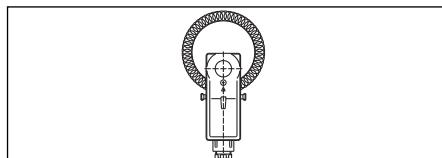
Fig. 49 Aquastat électrique avec réglage de température caché, plage de réglage 20-90°C (114 30 00).
