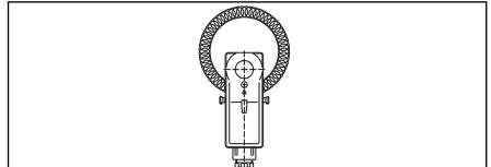
Fig. 49 Regolatore elettrico a contatto con impostazione della temperatura nascosta, campo di regolazione 20-90°C (114 30 00).
