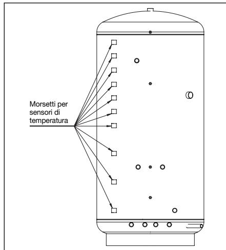
Fig. 6 Serbatoio con isolamento smontato
