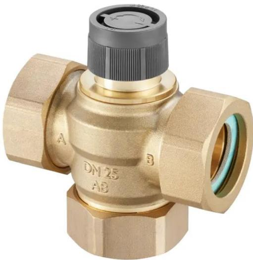
Le Tri CTB est un robinet à trois voies qui peut être utilisé comme robinet inverseur ou mitigeur. Pour être utilisé comme robinet inverseur, le Tri CTB a une entrée (AB) et deux sorties (A et B). En fonction de la position de la tige, le fluide circulant est dévié vers l'une ou l'autre sortie du robinet.
