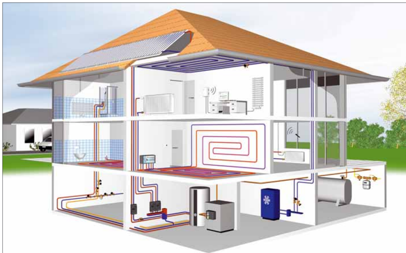
Příklad: Výstavba solární soustavy v rodinném domku
