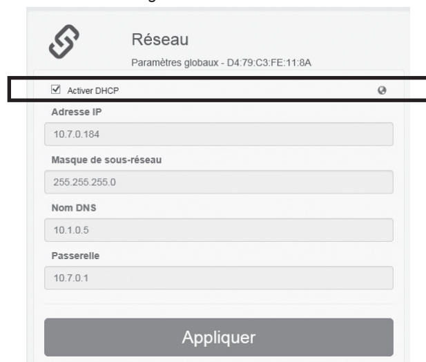
Fig. 115: Connexion au réseau du bâtiment
