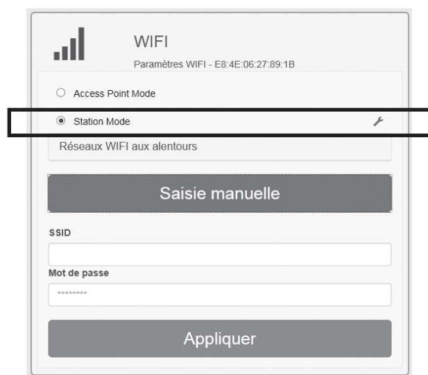
Fig. 114: Connexion au réseau WIFI
