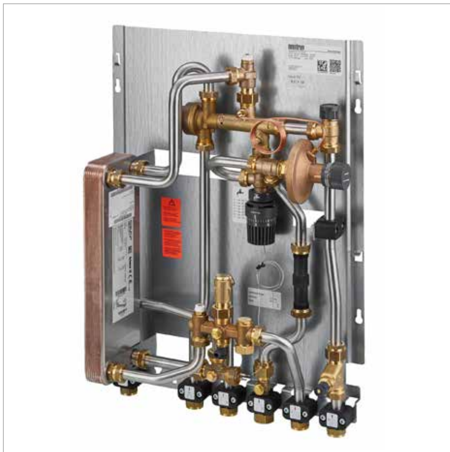
Regudis W-HTU woningstation met plaatwarmtewisselaar voor de overdracht van de warmte van een centrale bron naar de sanitaire en verwarmingsinstallatie in een woning.
