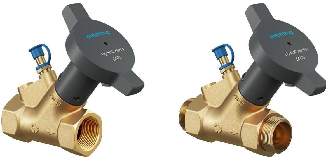
Le robinet d'arrêt HydroControl A sert à la fermeture de la tuyauterie dans les installations de chauffage et de rafraîchissement. Il se compose d'un corps à siège incliné optimisé en termes de débit, d'un mécanisme à étanchéité par deux joints toriques avec poignée manuelle ergonomique et d'un robinet auxiliaire HydroPort. Tous les éléments de commande sont disposés sur la face frontale.
