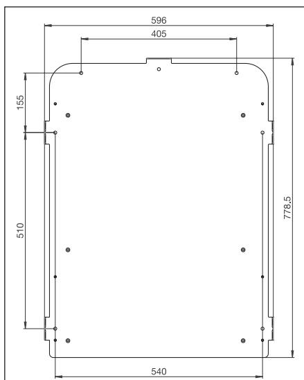
Abb. 4.1 Befestigungspunkte Wandbefestigung
