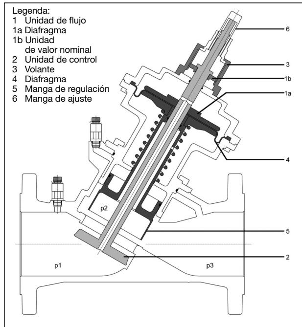
Figura 5 Construcción de la válvula "Cocon QFC/QGC"
