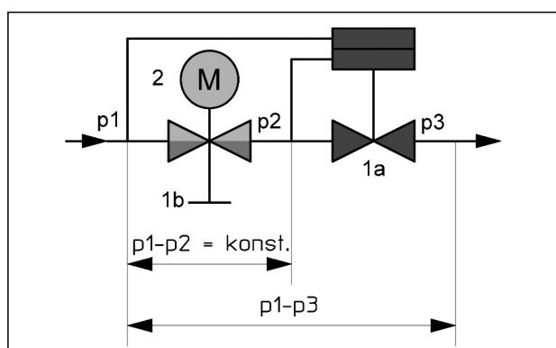
Figura 6 Principio de funcionamiento de la válvula "Cocon QFC/QGC"
