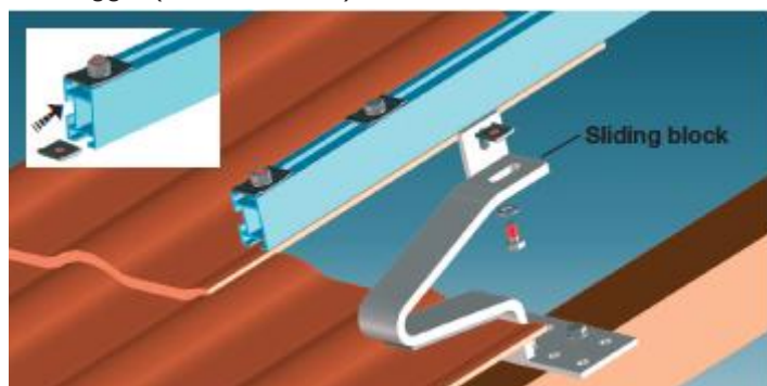
Illustr. 7: Fissaggio delle guide di montaggio
