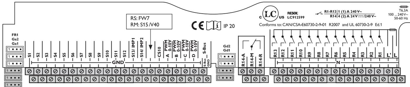
Branchez la sonde d'irradiation **CS10** sur les bornes CS10 et GND en tenant compte de la polarité. Pour ce faire, connectez le câble GND de la sonde au bloc de bornes de masse pour sondes du régulateur et le câble CS à la borne CS10 du régulateur.
