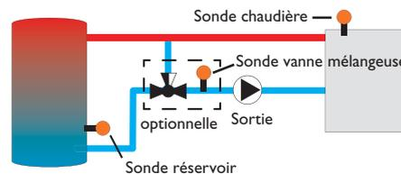
La fonction **Chaudière à combustible** solide permet de transférer la chaleur d'une chaudière à combustible solide vers un réservoir.
