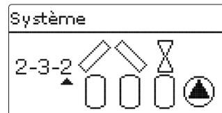
L'image exemplaire indique le système 2.3.2. où chaque champ de capteurs est doté d'une vanne à 2 voies et le réservoir est actionné par des pompes.
