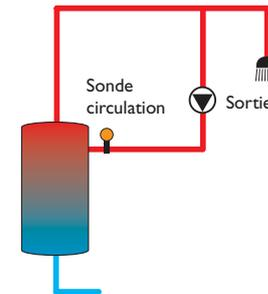
La fonction **Circulation** sert à régler et contrôler le fonctionnement des pompes de circulation.
