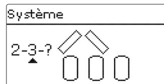
Vous pouvez ensuite sélectionner la variante hydraulique. La variante choisie s'affiche sur l'écran avec des symboles de pompes et de vannes. L'image exemplaire indique le système 2.3.2. où chaque champ de capteurs est doté d'une vanne à 2 voies et le réservoir est actionné par des pompes.
