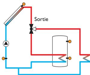
La fonction **Évacuation de l'excès de chaleur** sert à dissiper l'excès de chaleur vers un échangeur thermique externe (p. ex. fan coil) afin d'éviter une surchauffe des capteurs lors de journées très ensoleillées.
