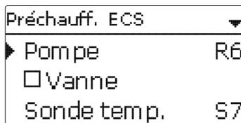
La fonction **Préchauffage ECS** sert à chauffer l'entrée d'eau froide du réservoir ECS en utilisant la chaleur d'un réservoir tampon.
