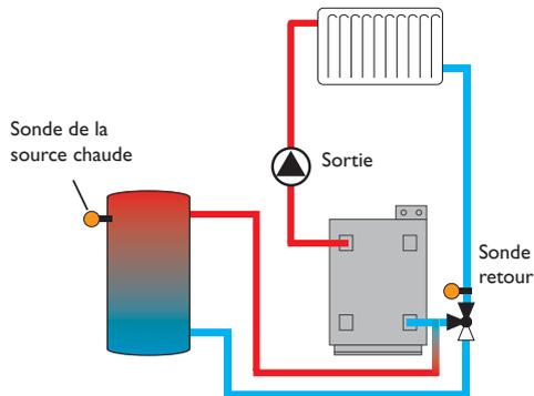
La fonction **Augmentation de la température du retour** permet de transférer la chaleur d'une source chaude au retour du circuit de chauffage.
