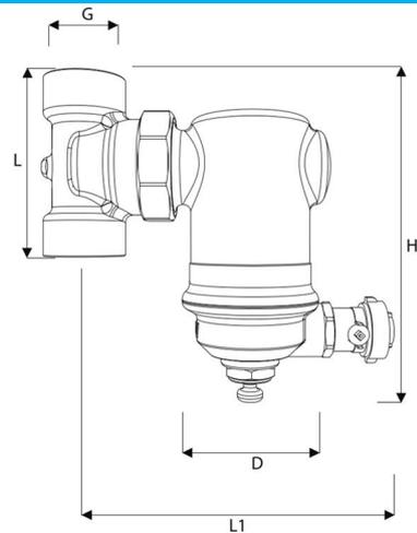
DN 20 et DN 25, pour montage vertical
