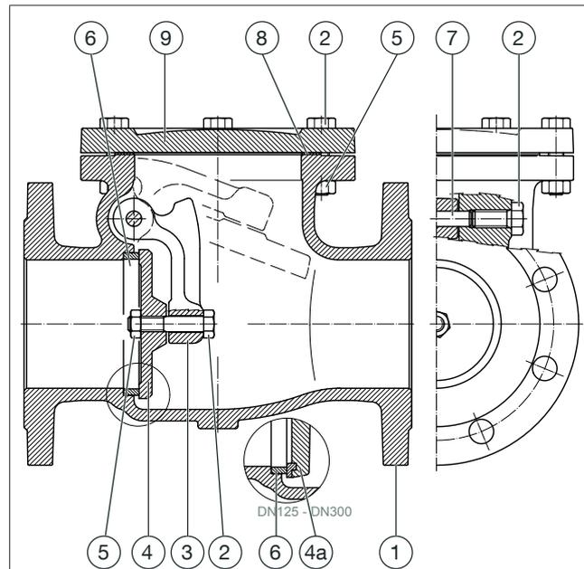
Fig. 1 : Configuration du clapet de retenue à battant
