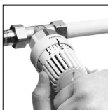
Fig. 7: Apăsăți puternic sau loviți mânerul cu podul palmei până când acesta se fixează în locașul lui. Intervalul de setare al termostatlui este acum limitat. Acum se pot seta numai valori cuprinse între cifra „2” și cifra „4” (cca. 16 °C - 24 °C).
