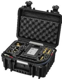
Système pour la mesure du débit au niveau des robinets et pour l'équilibrage d'installations de chauffage et de rafraîchissement. Le système peut être utilisé en combinaison avec la robinetterie Oventrop équipée de prises de pression Classic ou Eco ou de robinets auxiliaires HydroPort : HydroControl, HydroCom, Cocon, Hycocoon et orifices de mesure.
