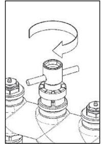
4. Régler la flèche de la bague de réglage sur le marquage de la clé de pré-réglage.
