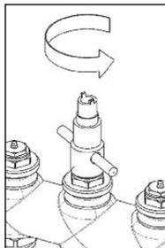
2. Poser la bague graduée et la clé de pré-réglage.
