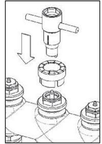
3. Den Bypass, durch drehen der Bypassspindel im Uhrzeigersinn, schließen.
