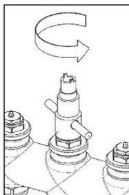
2. Aufsetzen von Einstellring und Voreinstellschlüssel.
